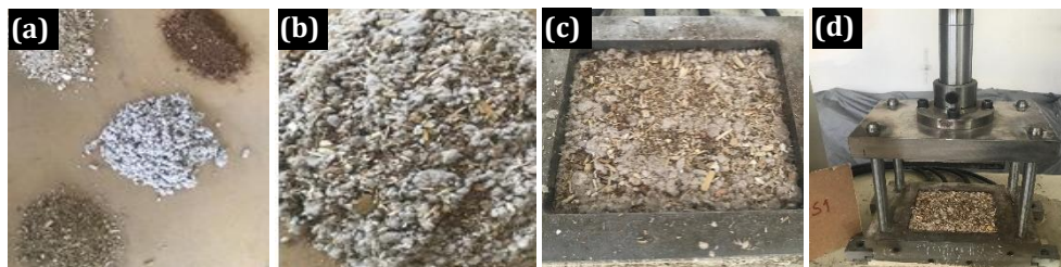
Şekil 6. 2. Grup numune hazırlama (a) numune hazırlama, (b) numune karışımı, (c) kalıba yerleştirme, (d) presleme.
