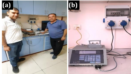
Şekil 14. Deney esnası (a) ısı iletim probu (b) QTM 500 cihazı.
