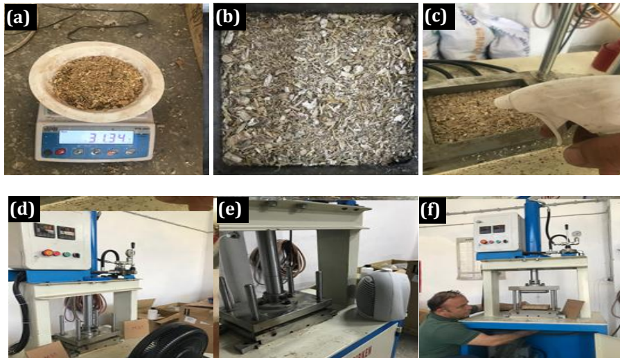
Şekil 4. 1. Grup (saf) numune üretim süreçleri (a) hassas terazi, (b) kalıba yerleştirme, (c) epoksi püskürtme, (d) presleme, (e) ısıtma, (f) presten çıkarma.
