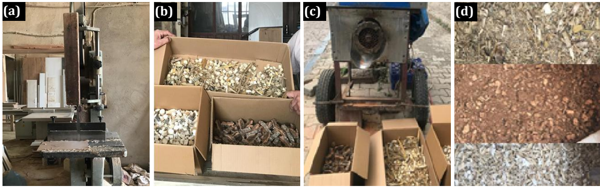
Şekil 2. Kaba ve ince tanelleme (a) şerit testere, (b) kaba taneler, (c) öğütme, (d) öğütülmüş ürün.
