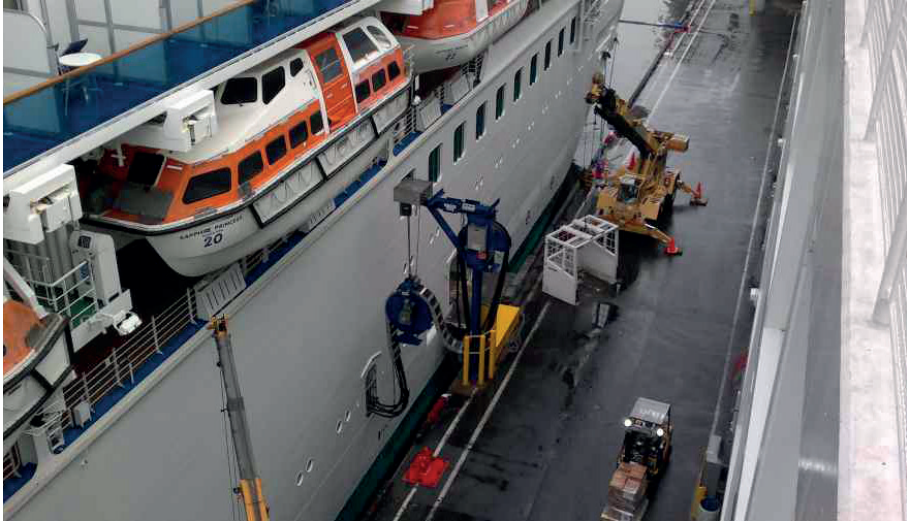
Şekil 7: Vancouver Kruvaziyer Limanında Elektrik Kaynağı (Notteboom vd., 2022)
