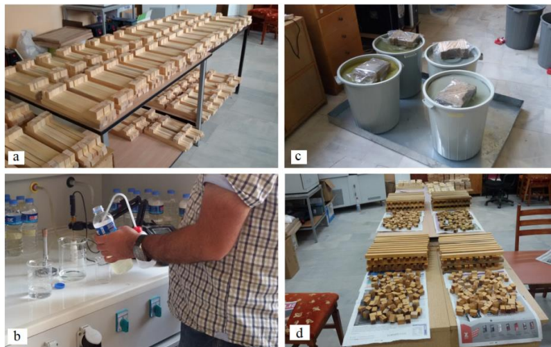
Şekil 1. Deney örnekleri (a), pH ve yoğunluk ölçümü (b), emprenye işlemi (c), emprenyeli örnekler (d) (Doğan, 2018)
