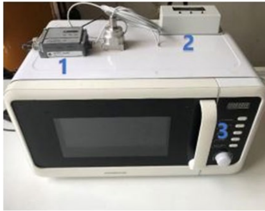
Şekil 1. Sıcaklık kontrollü mikrodalga kurutucu (SKMW) Figure 1. Temperature controlled microwave dryer (SKMW)
