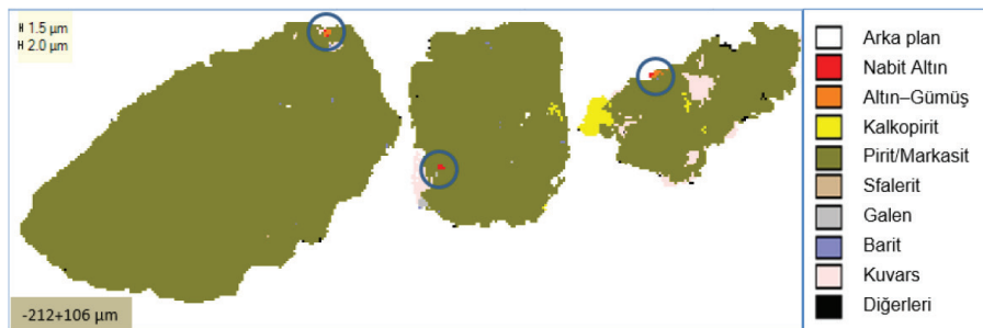
Şekil 2. -212+106 \mu m tane boyu aralığındaki altın içeren taneler.
