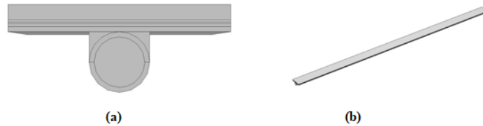
Şekil 1. Sayısal simülasyonda kullanılan tek tüplü PVT toplayıcının önden görünümü (a) ve izometrik görünümü (b)
