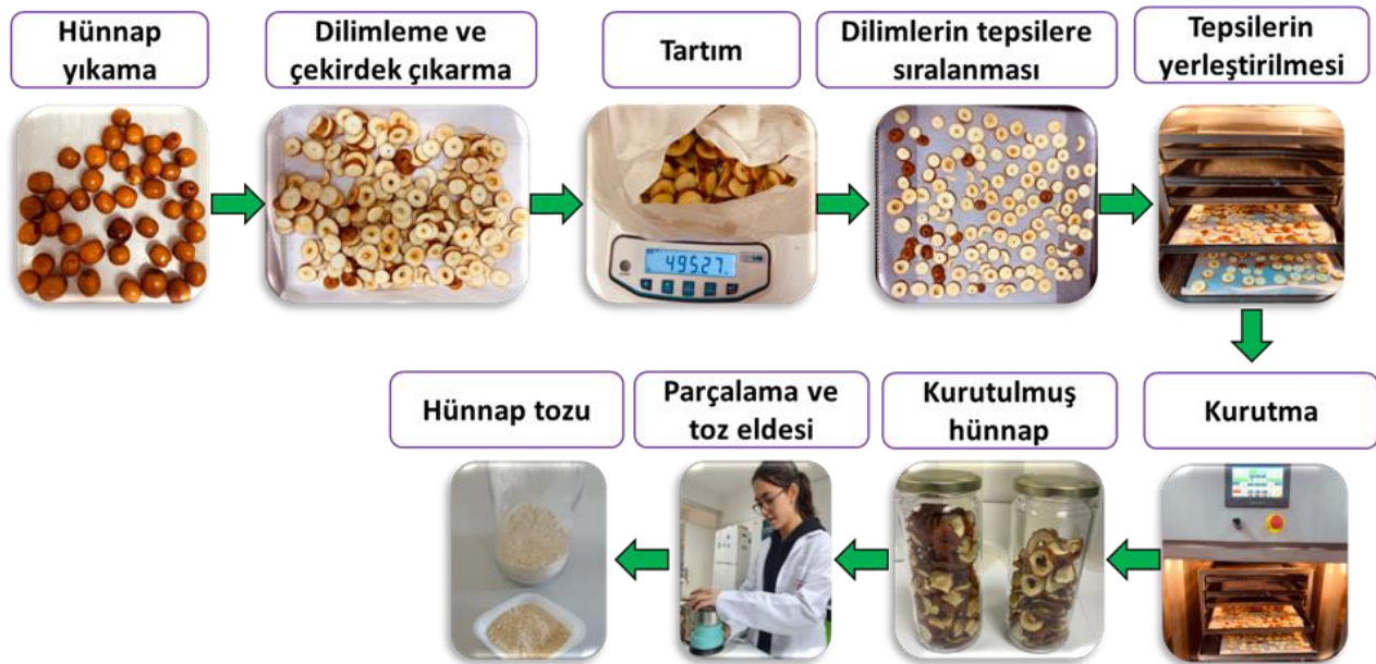
Şekil 1. Hünnap tozu üretim akış şeması
