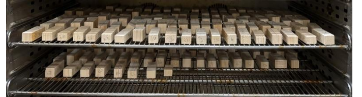
Şekil 4. Çekme testlerinden sonra kesilen yoğunluk ve rutubet örneklerinin kurutulması
