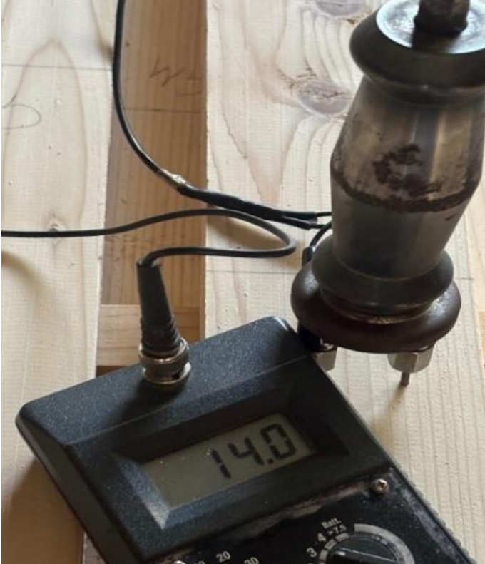
Şekil 1. Diren tipi rutubet ler (Hydrometer HT 65, GANN, Almanya) ile rneklerde rutubet miktarının belirlenmesi
