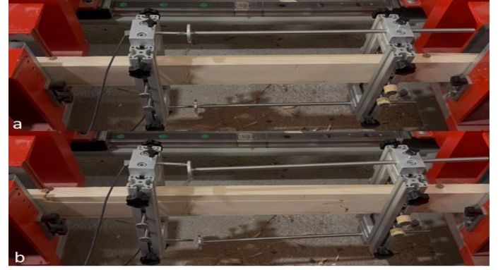
Şekil 3. TS EN 408 (2014) standardına göre liflere paralel çekmede elastikiyet modülü (3a) ve liflere paralel çekme direnci (3b) test düzeneği
