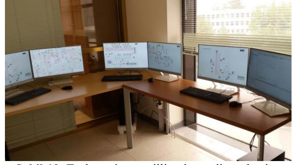
Şekil 10. Türkmenistan milli yük tevzii merkezine kurulan operatör eğitim simülâtöründen alınan bir resim (A)
