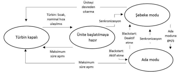
Şekil 4. Gaz santralinin temel çalışma prensibi
