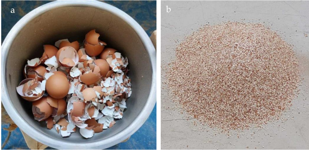
Şekil 2. (a) Atık durumunda ve (b) 0-1 mm aralığına getirilmiş yumurta kabuğu görüntüleri
