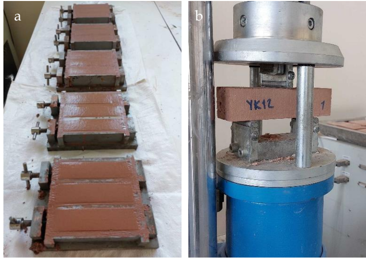
Şekil 3. (a) Kalıplara doldurulmuş Horasan harç örnekleri ve (b) eğilme dayanımı deney görüntüsü
