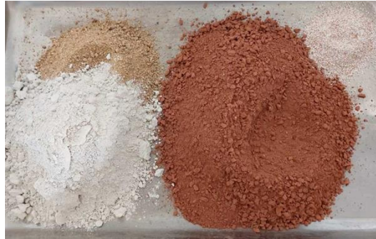
Şekil 1. Horasan harcı üretiminde kullanılan kireç, kum, tuğla kırığı ve yumurta kabuğu
