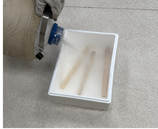
Şekil 1. Karaçam odunu örneklerinin sıvı azot ile muamelesi
