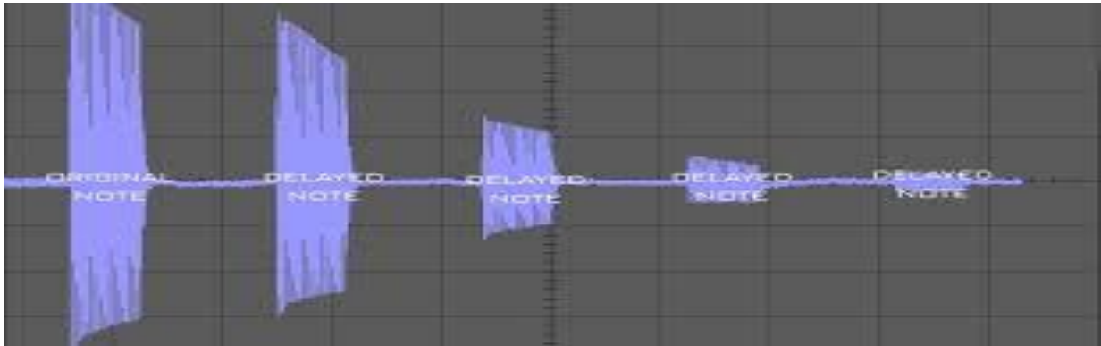
Şekil 5. Delay efektinin ses dalgaları ile örneklendiği
