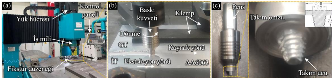
Şekil 1. SKK deney platformu ve süreci, a) SKK makinesi, b) Fikstür düzeneği, c) Karıştırıcı uç geometrisi ve ölçüleri (FSW experimental platform and process: a) FSW machine, b) welding experimental setup, c) stir tool geometry and dimensions)
