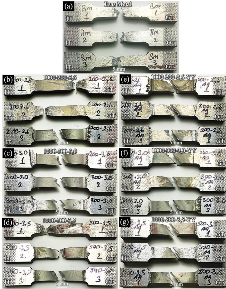
Şekil 10. Numunelerin kırılma konumları, (a) Esas metal, (b-d) Kaynak durumu, (e-g) Kaynak sonrası yapay yaşlandırma durumu (Fracture locations of the specimens: (a) Base metal, (b-d) As-welded condition, (e-g) Post-weld artificial aging condition)
