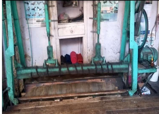
Görüntü 38: Pişirme işlemi için rulo yapılan keçe yüzeyin tepme tezgahına yerleştirilmesi Bozkurt, 2010
