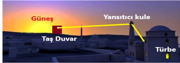
Şekil 3. Türbe ışık mekanizması.
