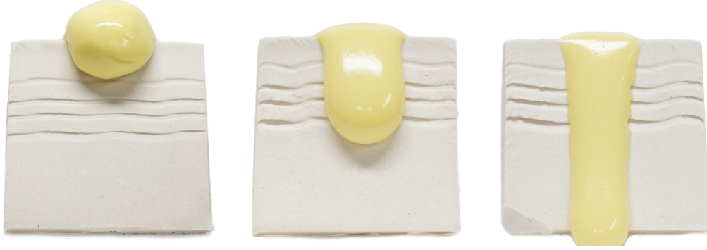
Görsel 1. Soldan sağa doğru sert gloop , normal gloop ve yumuşak gloop (Au, 2020)
