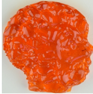
Görsel 12. 650 °C'de ergitme sonrası numunenin görünümü (Yazarın kişisel arşivinden).
