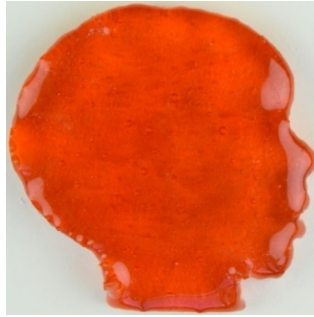
Görsel 13. 675 °C'de ergitme sonrası numunenin görünümü (Yazarın kişisel arşivinden).
