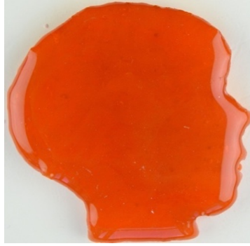
Görsel 16. 750 °C' de ergitme sonrası numunenin görünümü (Yazarın kişisel arşivinden).
