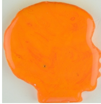
Görsel 18. 850 °C'de ergitme sonrası numunenin görünümü (Yazarın kişisel arşivinden).
