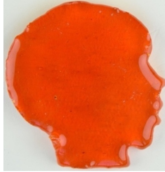
Görse 14. 700 °C'de ergitme sonrası numunenin görünümü (Yazarın kişisel arşivinden).
