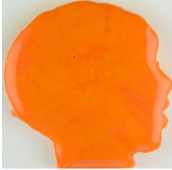
Görsel 17. 800 °C'de ergitme sonrası numunenin görünümü (Yazarın kişisel arşivinden).
