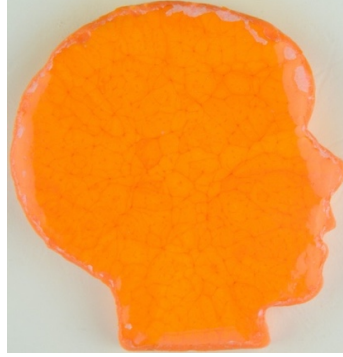
Görsel 19. 900 °C'de ergitme sonrası numunenin görünümü (Yazarın kişisel arşivinden).
