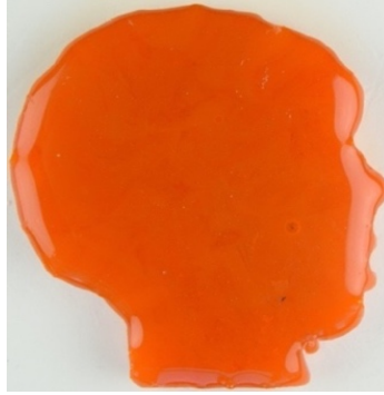
Görsel 15. 725 °C'de ergitme sonrası numunenin görünümü (Yazarın kişisel arşivinden).
