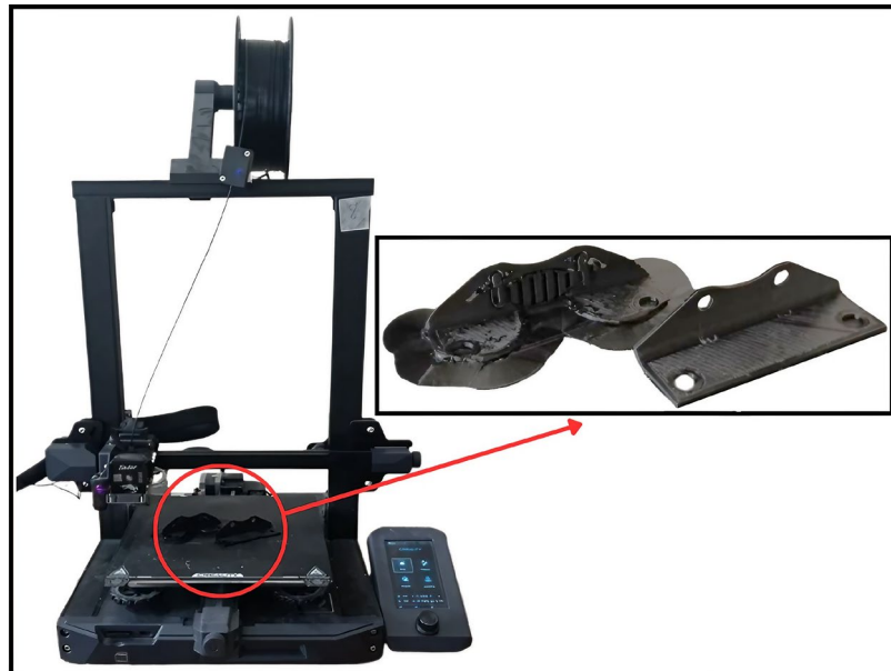
Şekil 12. EYM cihazı kullanılarak üretilen orijinal ve optimum parça (Original and optimal parts produced using the FDM device)
