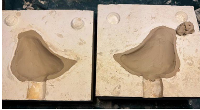
Görsel 1. Alçı kalıpta elle şekillendirilmiş form
