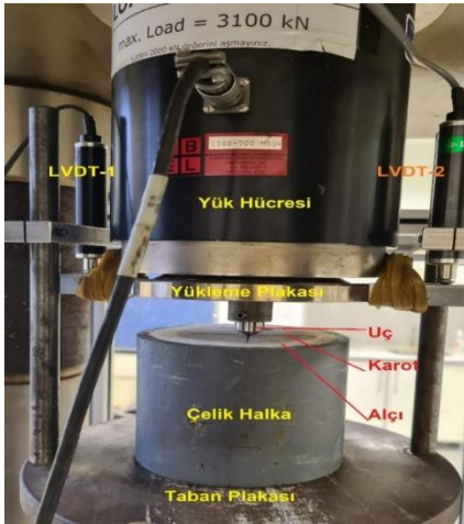
Şekil 1. Uç batırma deneylerinde kullanılan katı pres ve deney aparatları.
