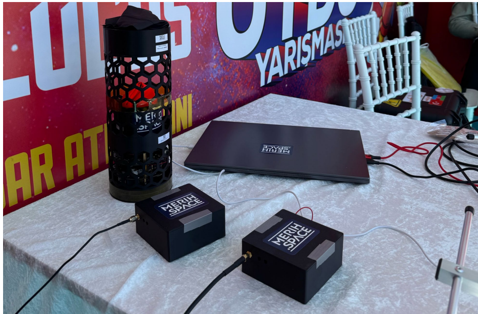
Şekil 10. Yer istasyonu bilgisayar, iki adet IoT istasyonu ve uçuş sistemi.
