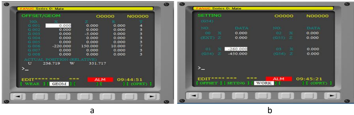
Şekil 8: Ofset Sayfası a) Kesici takım ofset sayfası b) İş parçası ofset sayfası
