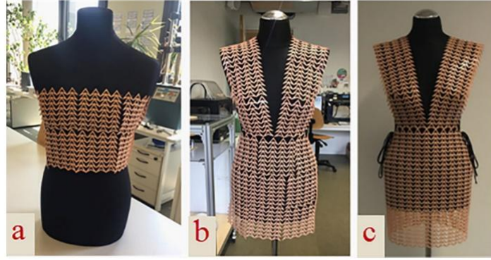
Şekil 10. a) Bir manken üzerinde iğne ile dikilerek bir araya getirilen 3B baskılı parçalar, b) Elbisenin tamamı ve c) Her iki tarafında kemerler bulunan bitmiş elbise [78] (a) 3D-printed pieces sewn together on a mannequin, b) the entire dress, and c) the finished dress with belts on both sides)
