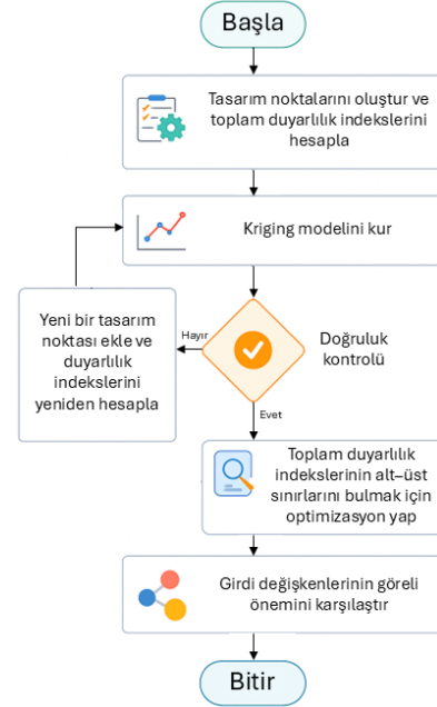
Şekil 1. Kriging tabanlı optimizasyonun genel akış şeması (General flowchart of Kriging-based optimization)
