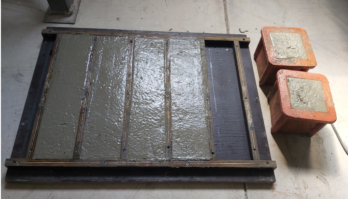
Şekil 2. Küp ve kiriş beton numuneleri
