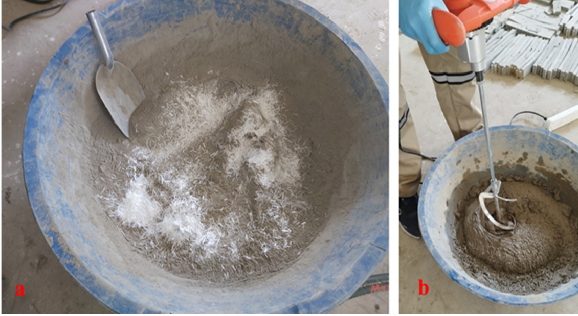
Şekil 1. a) Beton karışımına elyaf ilavesi b) Beton karışımın mikserle hazırlanması
