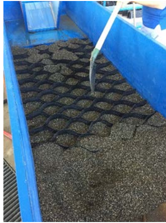
Şekil 3: HDS'nin kanala yerleştirilmesi
