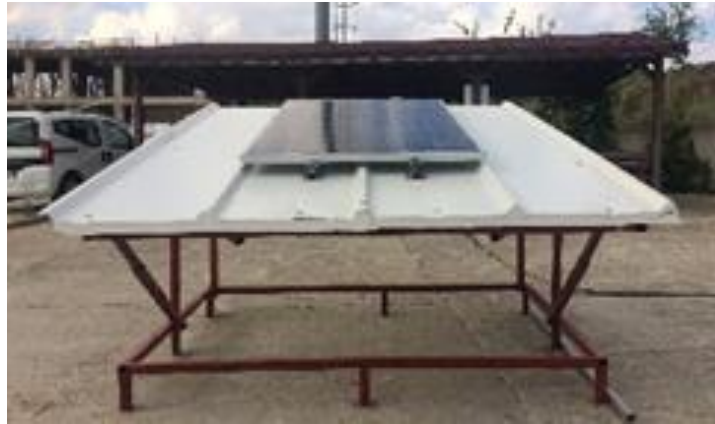
Şekil 5. Kurulumu yapılan olan polikristal silikon PV panel
