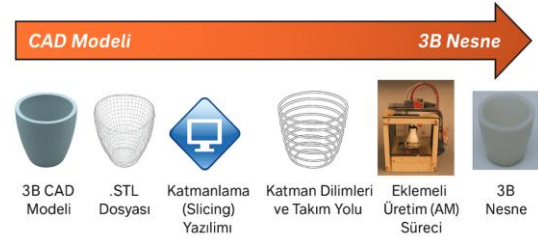
Şekil 5. Tasarım aşamasında 3B yazdırma safhaları (31)
