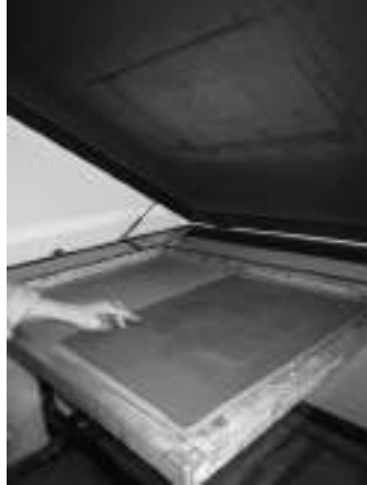
Görsel 28-29. Pozlama cihazında ve film ve eleğin yerleştirilmesi Bristol, İngiltere: University of West England, Dave Fortune Baskı Atölyesi.
