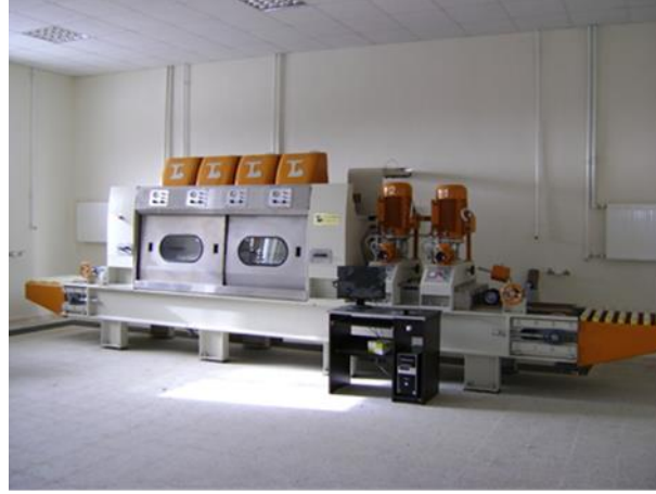
Şekil 1: Deneylerde kullanılan cila makinasının genel görünümü
