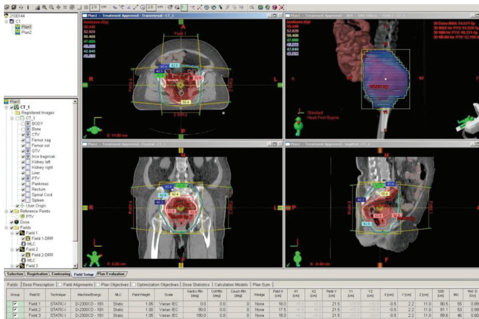
Şekil 13 • Radyoterapi planlama bilgisayarı ekranında aksiyel, koronal, sagittal planlardaki izodoz dağılımı ve lateral BEV görüntüsü
