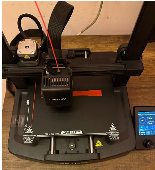
Şekil 1. Deneylerde kullanılan Creality Ender-3 V3 SE FDM yazıcısı ve baskı süreci
