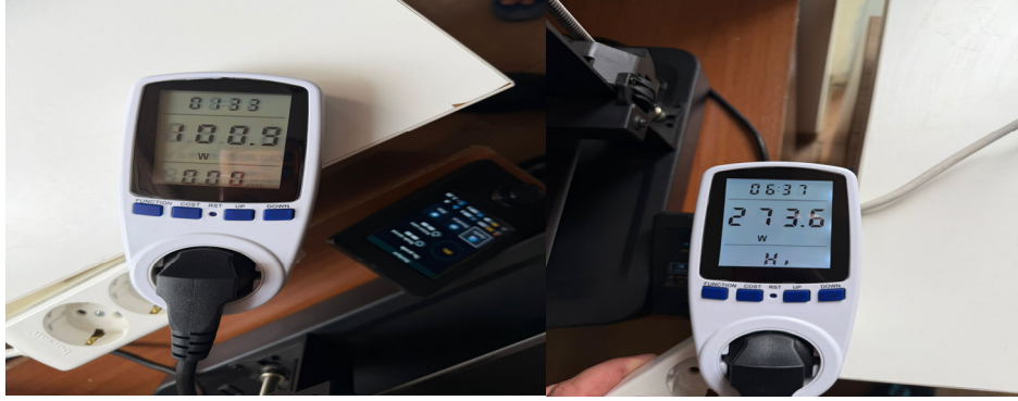
Şekil 2. TOGRAT dijital wattmetre ile baskı sürecinde gerçekleştirilen gerçek zamanlı enerji tüketimi ölçümleri: (a) baskının başlangıç aşaması, (b) baskı sırasında anlık güç tüketimi
