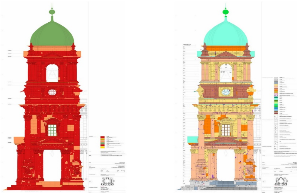
Şekil 12. Restorasyon süreci, C Kulesi'nin inşaat evreleri haritası (solda), C Kulesi'nin hasar haritası (sağda) (Goralczyk & Hoth, 2001).
