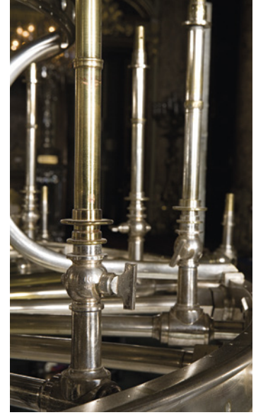
İngiliz kristali avizenin gümüş kaplamalı iskeletinde bulunan havagazı muslukları, Bir Döneme Işık Tutanlar 19. Yüzyıl Saraylarında Aydınlatma Araçları Koleksiyonu , s. 32.
