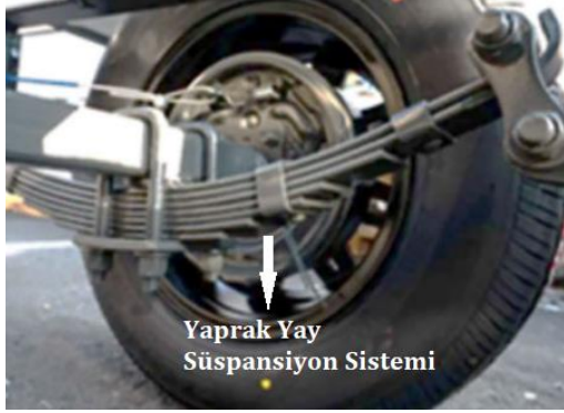
Şekil 1. Genel bir yük taşıma aracında kullanılan yaprak yay süspansiyon sistemi (A leaf spring suspension used in a typical load-carrying vehicle (LCV)) [1]
