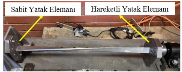
Şekil 7. Test düzeneğindeki yatak plakaları (Bearing Plates in the Test Setup)
