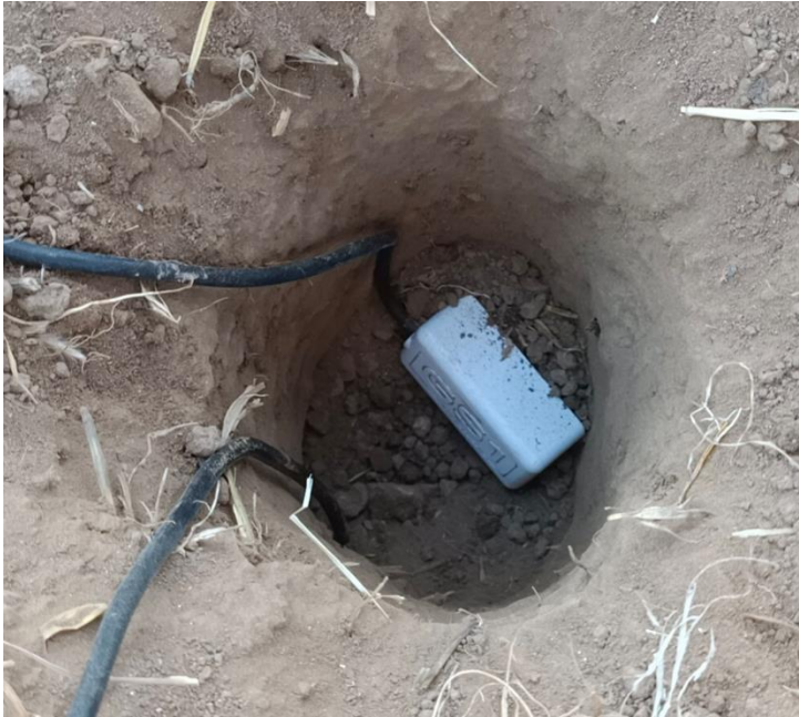
Şekil 2. Toprak nem sensörlerinin yerleştirilmesi
