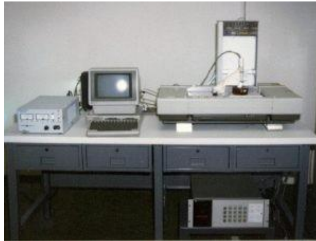
Görsel 1. Charles Hull tarafından geliştirilen ilk Stereolitografi (SLA) makinesi ve çalışma prensibi
