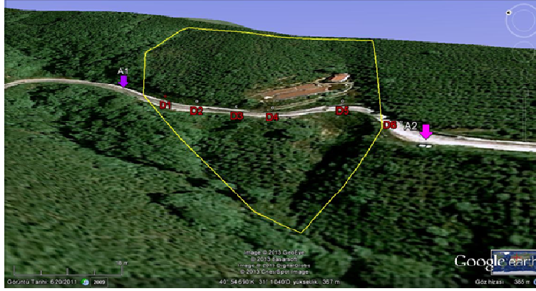
Şekil 5. Uydu görüntüsü üzerinde arazi çalışmalarının aplikasyonu (toprak kayması ile ilgili uydu görüntüsünde sarı çizgiyle sınırları tahmini belirlenen alanın yoldaki sınırlarına göre belirlenmiştir)
