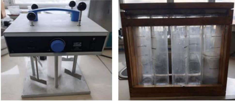
Şekil. 2. (a) Jar test cihazı; (b) Flokülasyon test cihazı.
