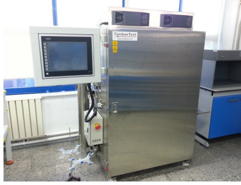
Şekil 1. Timber Test markalı 1 m 3 lük deney odası
