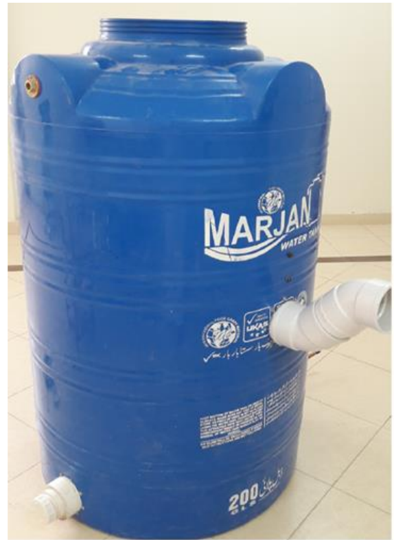
Fig. 1. A 750L biogas digester
