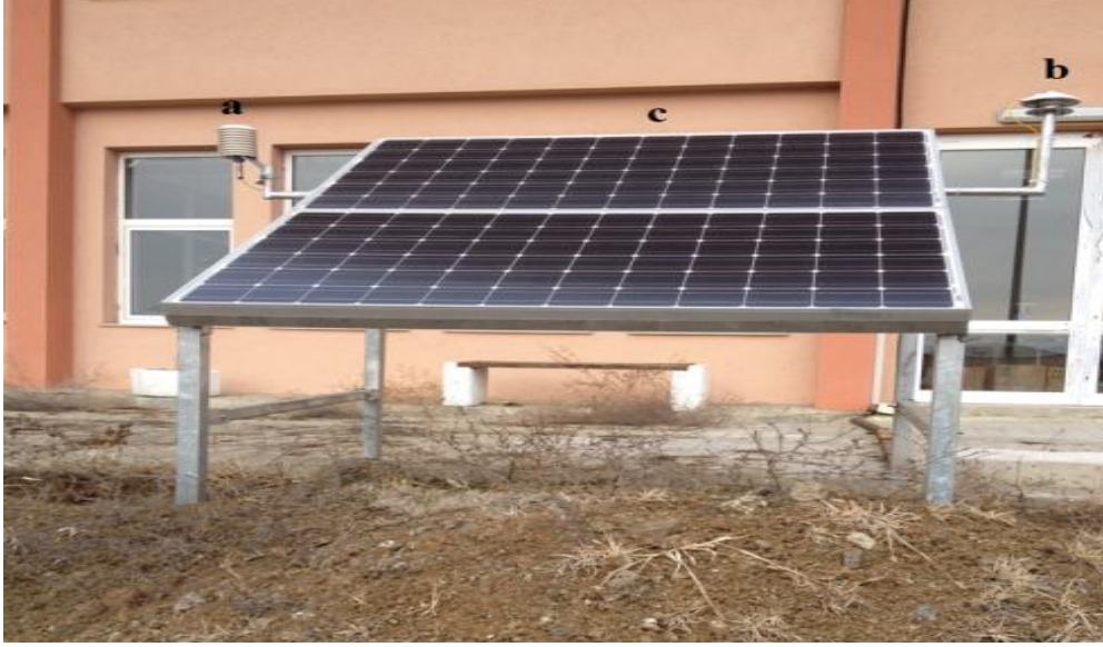
Şekil 18. FV sistem (a) Sıcaklık ve nem sensörü, (b) Işınım sensörü, (c) FV paneller (PV system (a) Temperature and humidity sensor, (b) Irradiance sensor, (c) PV panels)
