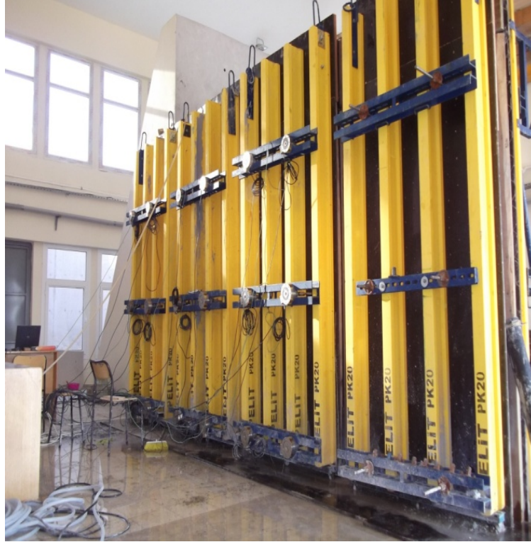
Şekil 3. Hazırlanan kalıplar ve kalıp yanal basınçlarının ölçüldüğü deney düzeneği (Lateral pressure of the formworks and formworks, prepared as measured experimental setup of) [7].
