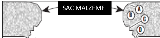
Şekil 4. Kesme işlemi sırasında kesme hattı boyunca sac malzemede oluşan geometri (A: Yuvarlanma, B: Kesme düzlüğü, C: Kopma, D: Çapak) (During the blanking process for blanking sheet material formed in line geometry (A: Rolling, B: Shear flat, C: Fracture, D: Burr) [21])
