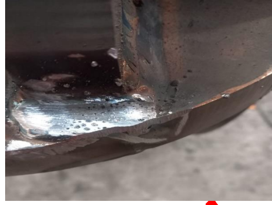
Şekil 1: Kaynakta oluşan gözenekler.
