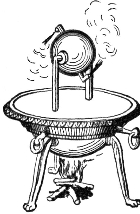
Şekil 1. Heron'un buhar türbinini şekli (Yörükoğulları vd., 2013).
