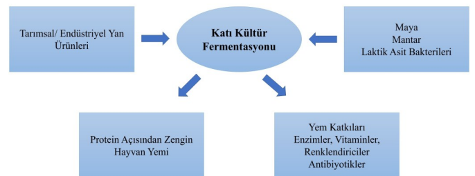
Şekil 1. Tarımsal ve endüstriyel yan ürünlerden katı kültür fermentasyon yolu ile yem ve yem katkıları üretimi (Ajila ve ark., 2012)
