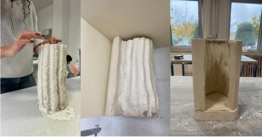
Görsel 4. Fatma Nur Sarıkaya, Kabak lifinin alt kısmının alçı ile sıvanması (solda) ve alçı kalıp alma süreci (sağda).
