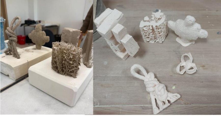
Görsel 3. Halat, strafor, tekstil, kabak lifi ve polimer sünger numunelerinin porselen astarla kaplanması (solda) ve kurutma sonrası 1000 °C’de pişirilmiş örneklerin görünümü (sağda).
