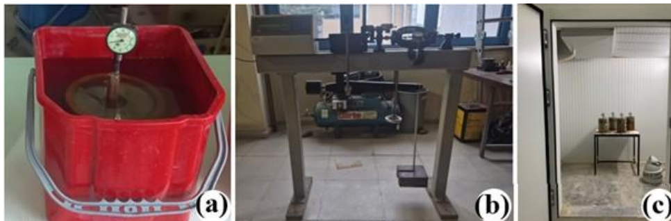
Şekil 3. Deneysel aşamalar a) numunelerin suda bekletilmesi b) kesme kutusu deney aleti c) donma-çözülme kabini
