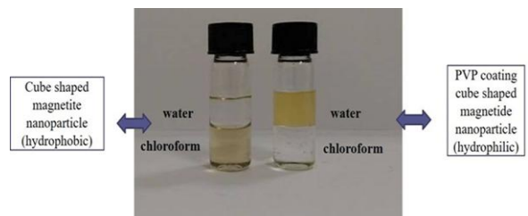
Figure 12. Photograph of cubic-shaped magnetic nanoparticles suspended in an aqueous medium following PVP coating (PVP kaplamasının ardından sulu ortamda süspansiyon halinde bulunan küp şeklindeki manyetik nanopartiküllerin fotoğrafı)
